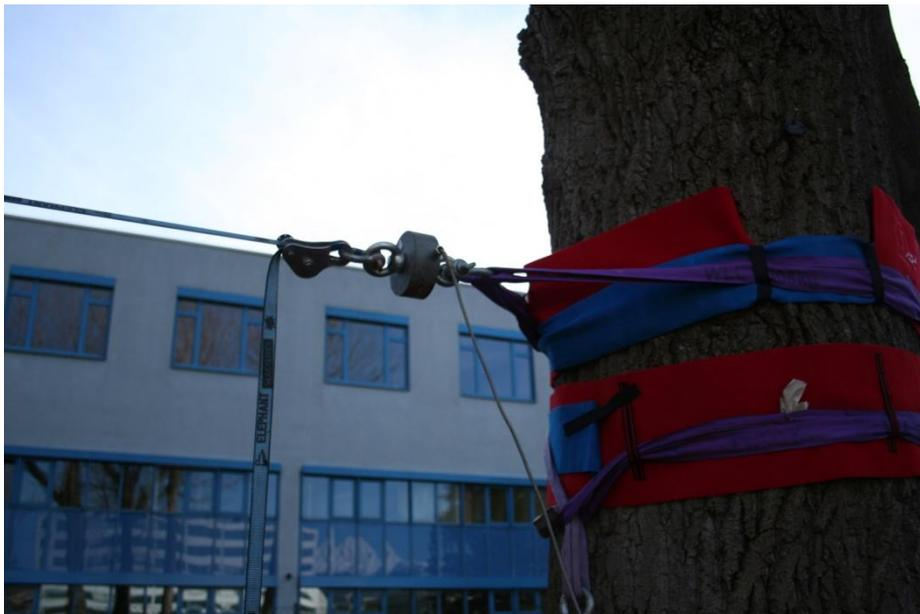
*Einbau der Kraftmessdose nach entfernen des Spannsystems bei Polyester und Polyamid*
