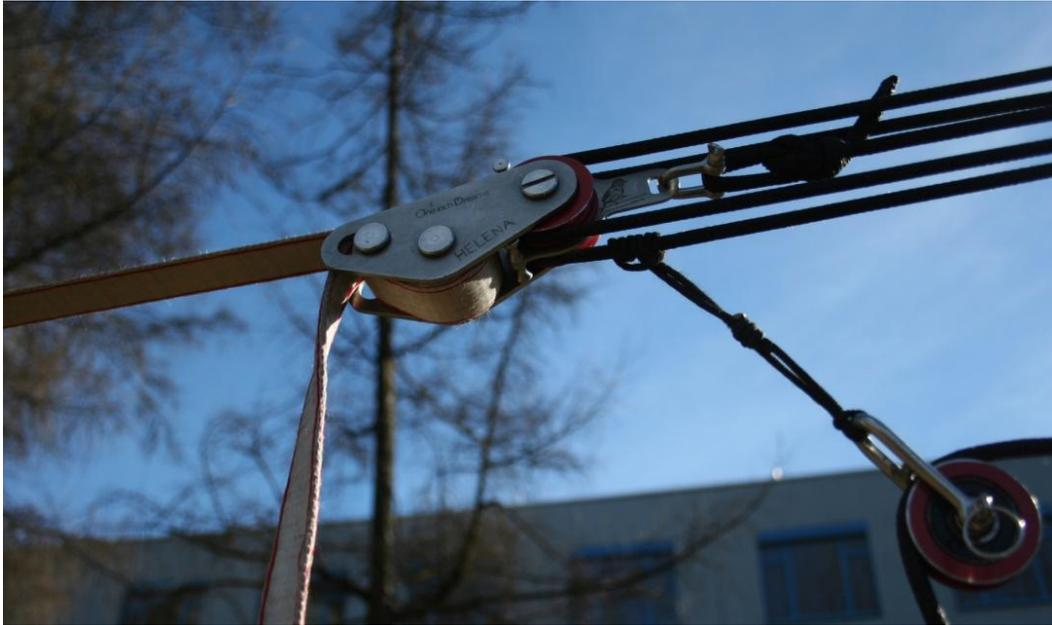
*Tests mit Dyneema: Flaschenzug mit Dyneemaseil bleibt mit Kraftmessdose im System*
